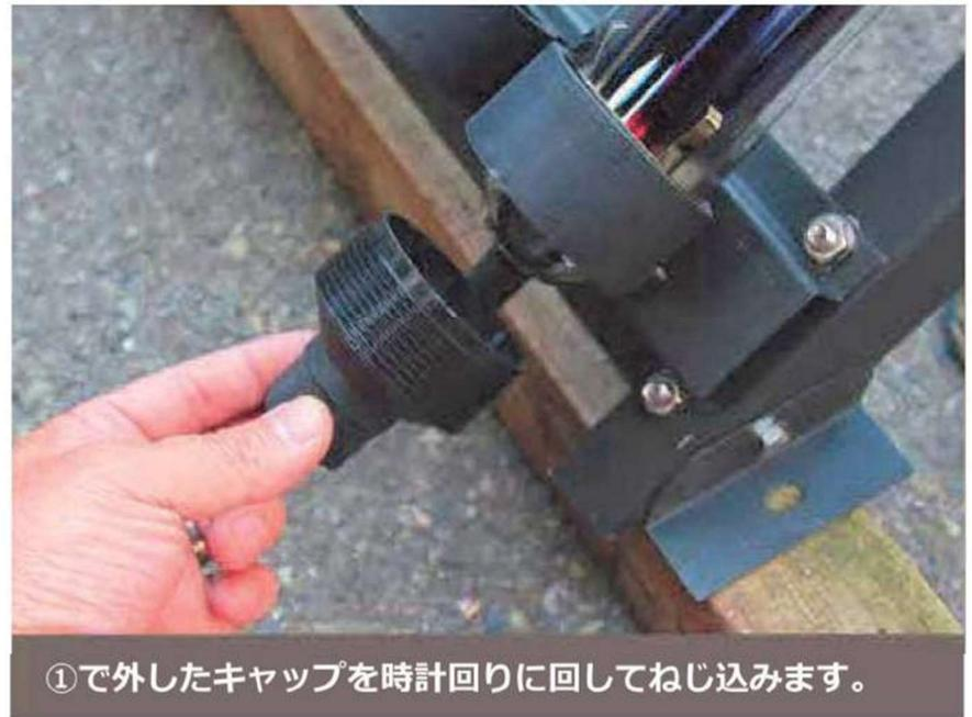
①で外したキャップを時計回りに回してねじ込みます。
